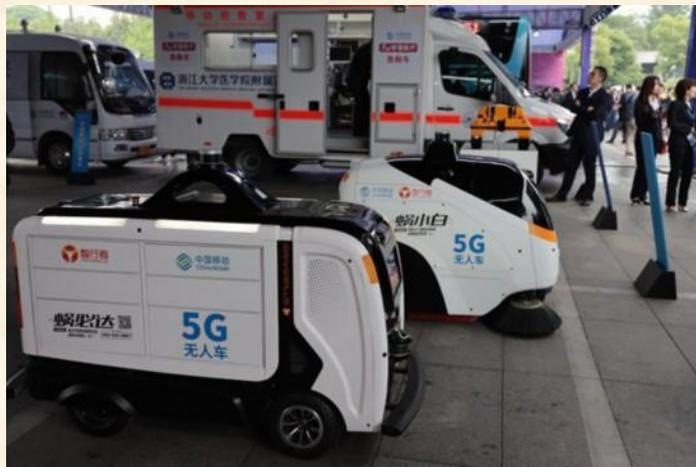
應用5G技術的無人掃地車和無人配送物流車。這台「移動5G螞小白-無人掃地車」通過搭載激光雷達等傳感器，結合具備360°全程監控和實時訊息交互的雲平台管理系統以及定時設置清掃時間，實現智能清潔環境衛生。
